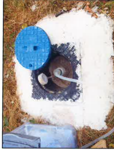
Prélèvement d'air du sol dans le piézair Pa2
