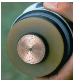
Câble à 225 000 volts
