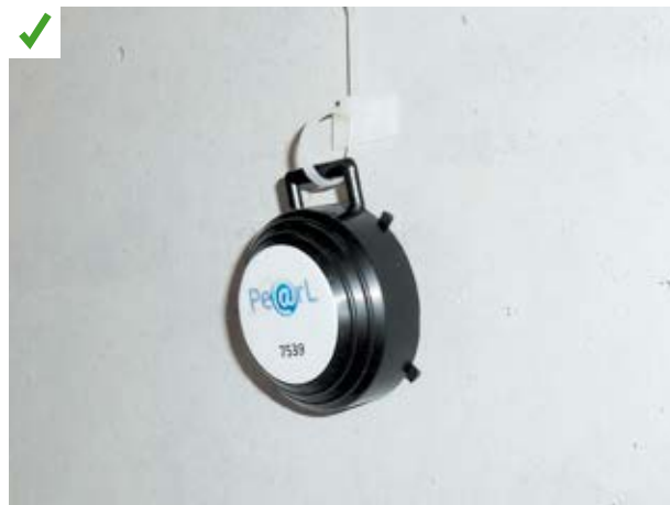
Dans chacune des pièces, la concentration de radon peut être mesurée à l'aide d'un dosimètre. ©AQC-2015
